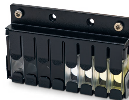
Внутри LinSet Запечатанные кюветы с р-рами CRM и нейтральные светофильтры
